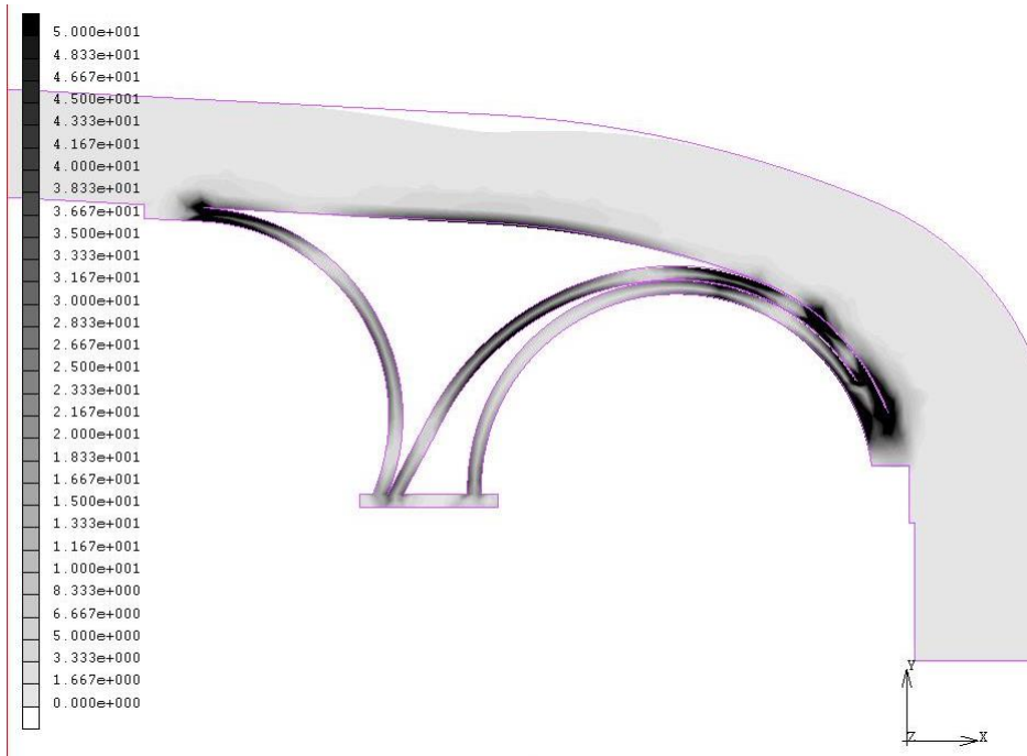
Bild 3: Vergleichsspannungen bei Belastung bei der Einbuchtung im Schaumstoff
