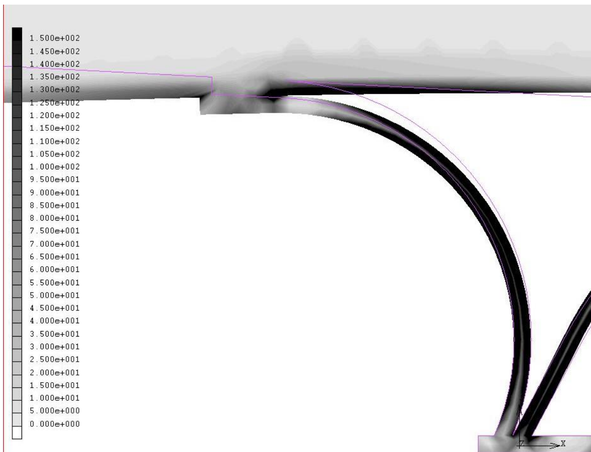
Bild 1: Vergleichsspannungen bei Belastung an der vorderen Kante
