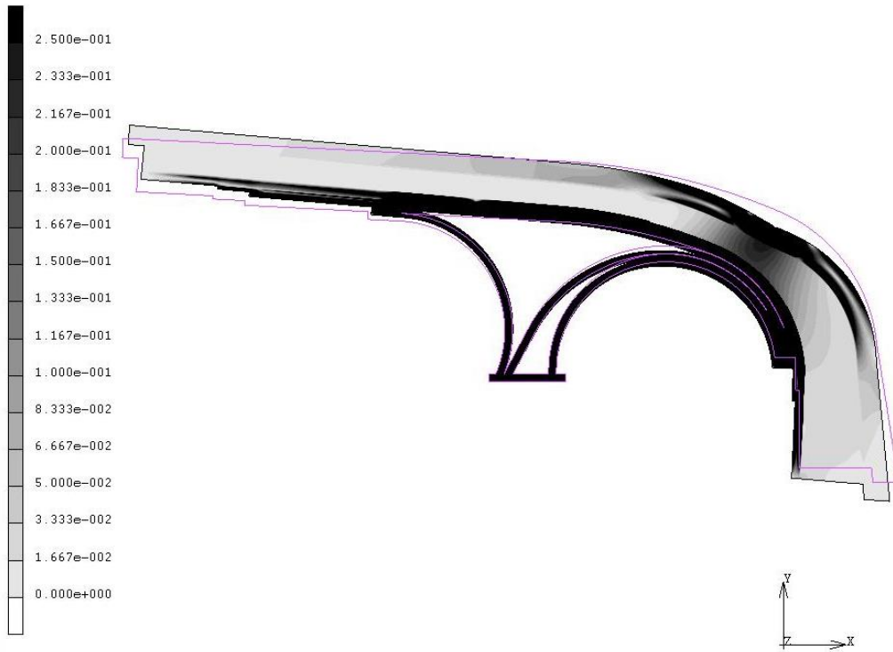
Bild 2: Vergleichsspannungen in der Schutzschicht in Netz C
